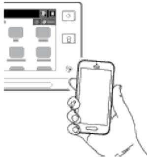
Das Mobilgerät und der Drucker kommunizieren miteinander. Das Netzwerk wird vom Mobilgerät nach dem Drucker durchsucht. Sobald der Drucker gefunden wurde, wird er der Liste als zugeordneter Drucker hinzugefügt. Nun können Druckaufträge vom Mobilgerät aus an den Drucker übermittelt werden.
