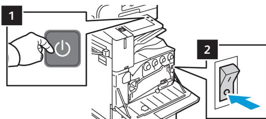
Para reiniciar la impresora, en el panel de control, pulse el **interruptor de alimentación secundario** (1).
