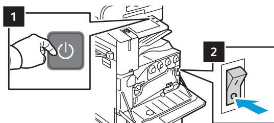
Для перезапуска принтера нажмите **дополнительный выключатель питания** (1) на панели управления.
