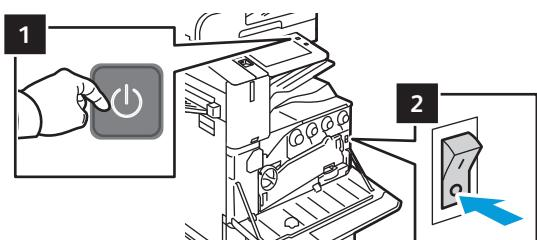
Če želite ponovno zagnati tiskalnik, na nadzorni plošči pritisnite **pomožno stikalo za vklop napajanja** (1).
