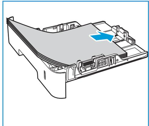
2. Pour pouvoir introduire du papier plus long, appuyez sur le levier d'extension du bac 1) et faites-le glisser vers la position souhaitée. Faites glisser le guide de longueur du papier (2) en appuyant dessus jusqu'à ce qu'il soit au contact de la pile de papier.
