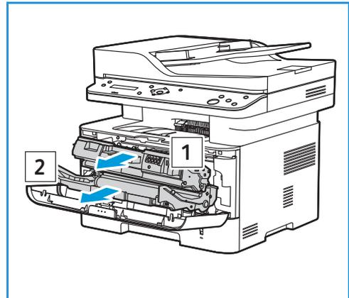
4. Retirez le module photorécepteur neuf de son emballage. Suivez les instructions figurant sur l'emballage pour retirer le ruban et les matériaux d'emballage. Pour éviter de toucher des pièces sensibles pouvant être endommagées facilement, tenez le module photorécepteur par la poignée.
