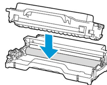
8. Réinsérez le module d'impression.
