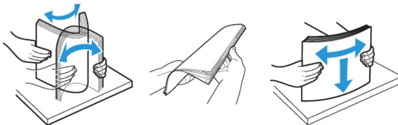
4. Den Papierstapel mit der zu bedruckenden Seite nach oben einlegen, und anschließend sicherstellen, dass die seitlichen Führungen eng am Papier anliegen.
