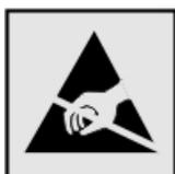
Mit diesem Symbol sind Teile gekennzeichnet, die gegen statische Aufladungen empfindlich sind. Vor dem Berühren der Bereiche um diese Symbole zuerst einen Metallgegenstand in einem entfernten Bereich zu dem Symbol berühren.
