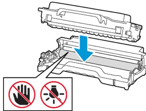
8. Réinsérez le module d'impression.
