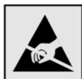
Ovim simbolom označeni su dijelovi koji su osjetljivi na statički elektricitet. Nemojte dodirivati područja blizu ovih simbola, a da prije toga ne dodirnete metalnu površinu u području dalje od simbola.
