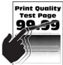
Σημείωση: Προτού επιλύσετε το πρόβλημα, εκτυπώστε τις δοκιμαστικές σελίδες ποιότητας εκτύπωσης. Από τον πίνακα ελέγχου, μεταβείτε στις επιλογές **Ρυθμίσεις > Αντιμετώπιση προβλημάτων > Δοκιμαστικές σελίδες ποιότητας εκτύπωσης**. Για μοντέλα εκτυπωτή χωρίς οθόνη αφής, πατήστε **OK** για να περιηγηθείτε στις ρυθμίσεις.
