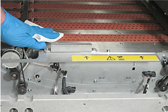
4. Rechts von jedem Band befindet sich ein Drehknopf. Den jeweiligen Knopf im Uhrzeigersinn drehen, um das Transportband zu bewegen, damit mehr Bereiche gereinigt werden können.
