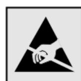
لتتجنب حدوث تلف ناجم عن التفريغ الكهربائي عند تنفيذ مهام الصيانة، مثل إزالة احتشار الورق أو استبدال المستلزمات، المس أي إطار معدني مكشوف للطابعة، قبل الوصول إلى المناطق الداخلية في الطابعة أو لمسها حتى إذا لم يكن الرمز موجوداً.
