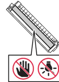
5. Das neue Druckmodul einsetzen.
