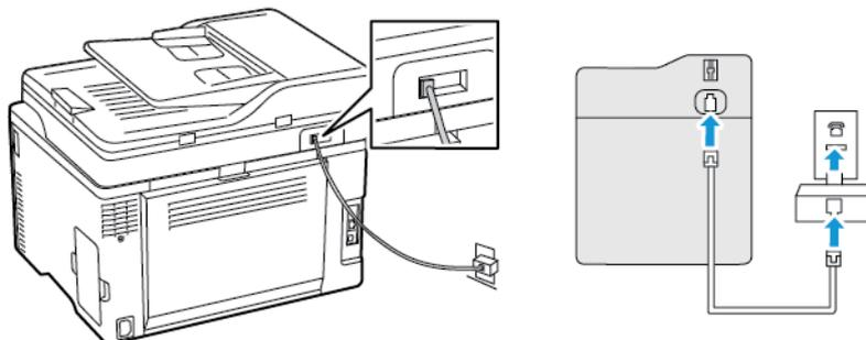
1. Conecte uma extremidade do cabo de telefone à porta de linha da impressora.
