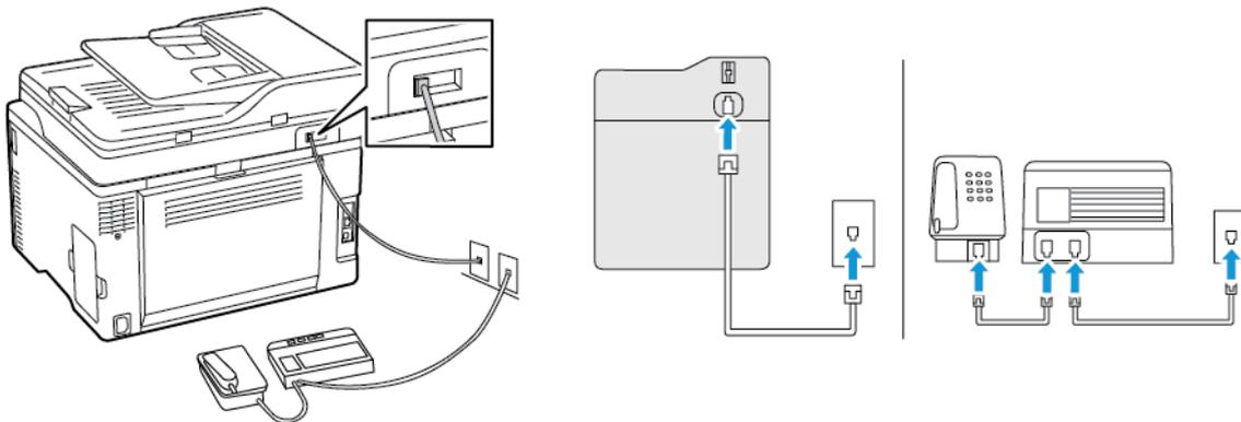
1. Conecte uma extremidade do cabo de telefone à porta de linha da impressora.
