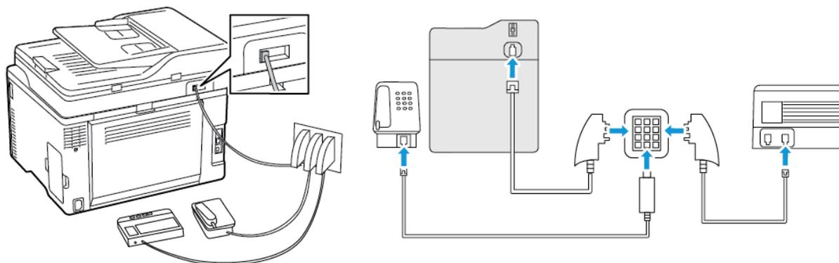
1. Conecte uma extremidade do cabo de telefone à porta de linha da impressora.
