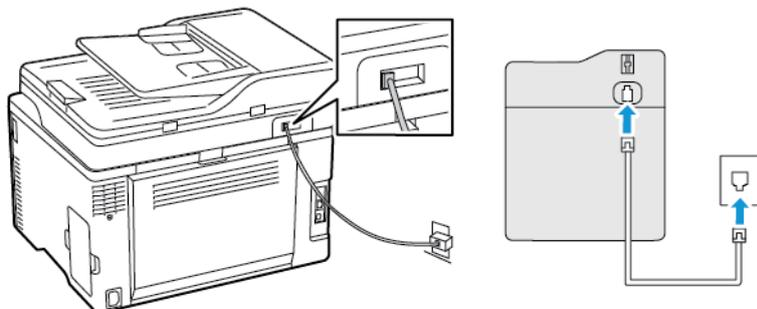
1. Conecte uma extremidade do cabo de telefone à porta de linha da impressora.
