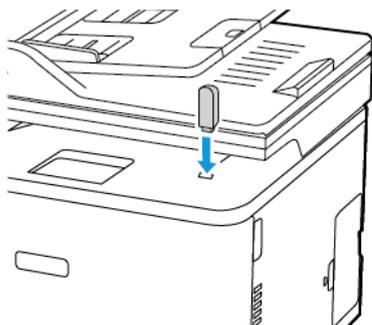
3. Toque em **Digitalizar para USB** e ajuste as definições, se necessário.
