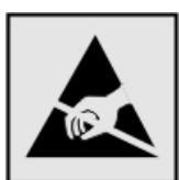
Acet simbol identifică componente cu sensibilitate statică. Nu atingeți zonele din apropierea acestor simboluri fără a atinge în prealabil o suprafață metalică dintr-o zonă aflată la distanță de simbol.
