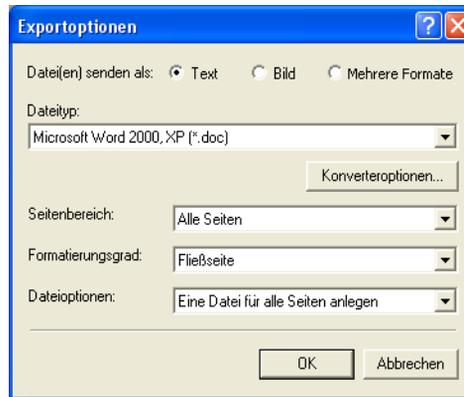
1. Legen Sie fest, was Sie senden möchten: Text, Bild oder mehrere Text- oder Bildformate. „Text“ eignet sich für erkannte Seiten, „Bild“ für Seitenbilder, „Mehrere Formate“ für das gleichzeitige Speichern in zwei oder mehreren Dateitypen. Siehe „Mehrfachkonverter verwenden“ auf Seite 106.
