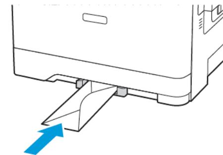
3. Avancez le papier jusqu'à ce que le bord d'attaque soit correctement inséré.
