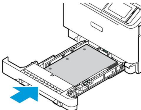
9. Coloque as etiquetas com a face para cima na bandeja e, em seguida, ajuste o comprimento e a largura das guias do papel para se ajustarem às etiquetas. Certifique-se de que a altura da pilha de papel esteja abaixo do indicador de preenchimento.
