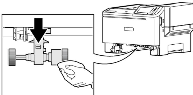
⚠ Importante: Se os rolos de alimentação do papel se soltarem durante a limpeza, assegure-se de instalá-los corretamente, conforme mostrado. A instalação incorreta dos rolos de alimentação pode resultar em atolamento de papel.
