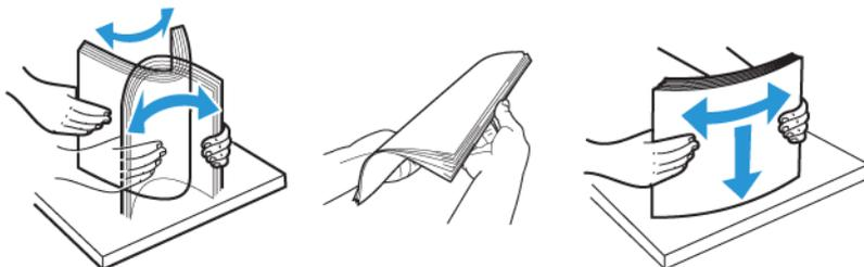
4. Coloque o papel timbrado com o lado a ser impresso voltado para cima e a borda superior entrando por último na impressora.
