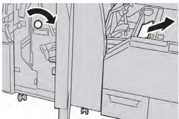
5. Die linke Abdeckung der Trimmer-Einheit schließen.
