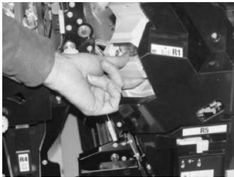
4. Falls erforderlich das Heftklammermagazin wie gezeigt anheben und die gestaute Heftklammer entfernen.
