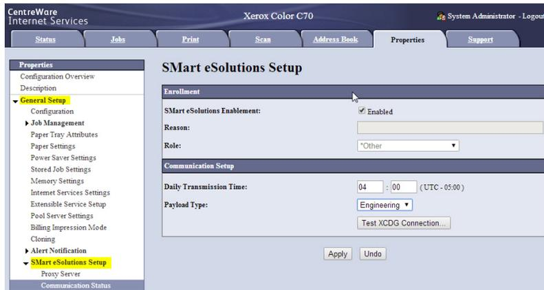
4. Na seção Configuração da comunicação, indique a hora do dia durante a qual você gostaria que ocorressem as transmissões de comunicação entre a impressora e o servidor de comunicação.
