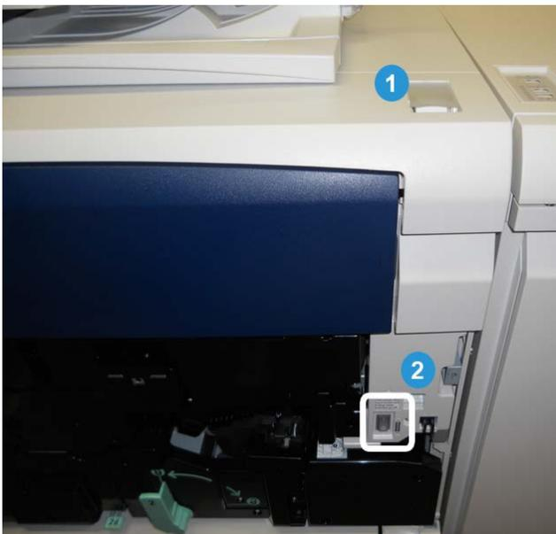
Das Gerät verfügt über zwei Netzschalter:
