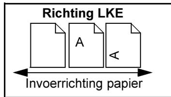
**Korte kant eerst (KKE) / Landschap** Gezien vanaf de voorzijde van het apparaat, originelen die met de korte kant aan de linker- en rechterzijde van de papierlade of automatische originelendoorvoer worden ingevoerd.
