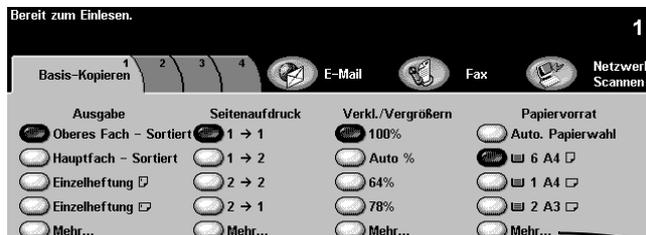
Durch Antippen von *Mehr...* wird der Bildschirm für die Papiervorratauswahl geöffnet.
