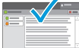
Pour économiser l'encre, maintenez l'imprimante allumée en permanence. Pour redémarrer l'imprimante avec la fonction Redémarrage rapide, appuyez deux fois sur le bouton **Économie d'énergie** afin de sortir de ce mode, si nécessaire. Sur l'écran tactile, sélectionnez **Redémarrage rapide**, puis **Redémarrer**. Si le processus de redémarrage ne commence pas dans un délai de 30 secondes, redémarrez l'imprimante à l'aide de l'interrupteur.
