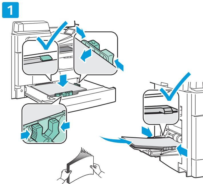
Pour obtenir les meilleurs résultats, ventilez les bords du papier. Réglez les guides en fonction du format de papier. Ne chargez pas de papier au-dessus de la ligne de remplissage maximal.
