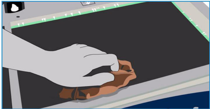
**Nota:** Manchas ou marcas no vidro são reproduzidas nas impressões ao copiar no vidro de originais. Manchas no vidro do Transporte de velocidade constante (a tira de vidro à esquerda) aparecerão como faixas nas impressões ao copiar no recirculador de originais.
