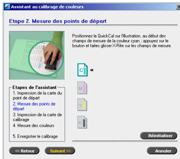
9. Tout en maintenant pressé le bouton sur le X-Rite DTP34, alignez la tête de X-Rite DTP34 sur la pointe de la flèche du cyan. La flèche est sur la gauche de la colonne cyan sur la courbe de calibrage de la densité de l'image. Sa pointe croise la ligne en pointillé.
