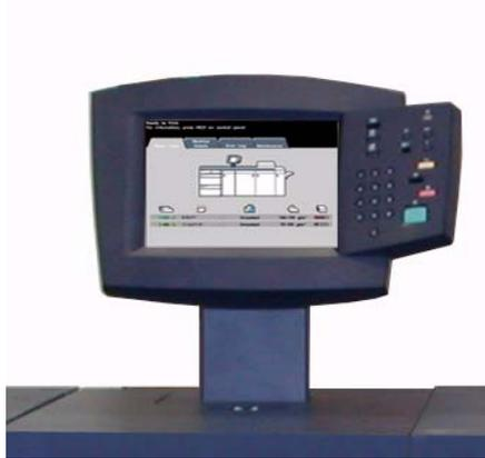
La pantalla prefijada puede ser la pantalla *Estado del trabajo* o *Estado de la máquina*.
