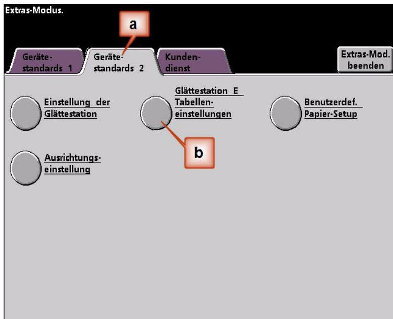
4. A curvatura permanece após ter tentado o Padrão do Sistema e as Configurações de tipo de papel de A a D do Eliminador de curvatura. Consulte “Configurações de tipo de papel de A a D do Eliminador de curvatura” na página 3. Como resultado, você precisa programar o Eliminador de Curvatura para usar o trajeto para baixo do eliminador de curvatura para remover a curvatura para baixo (convexa).
