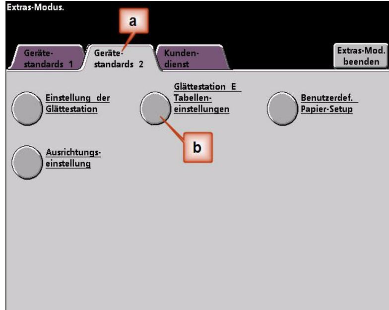
4. A curvatura permanece após ter tentado o Padrão do Sistema e as Configurações de tipo de papel de A a D do Eliminador de curvatura. Consulte [“Configurações de tipo de papel de A a D do Eliminador de curvatura”](#) na página 3. Como resultado, você precisa programar o Eliminador de Curvatura para usar a pressão para baixo (ou o rolo inferior) para remover a curvatura para baixo (convexa).
