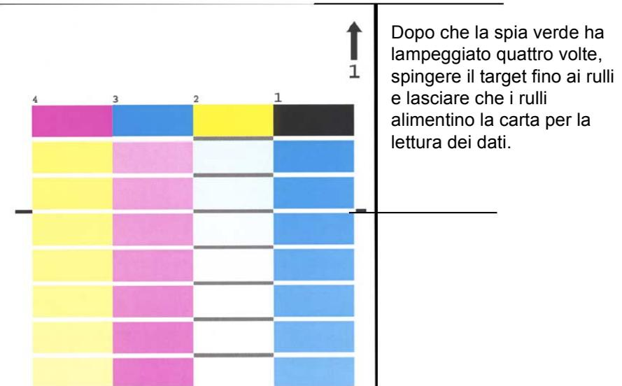
Figura 3-5. Calibratura - Quarto passaggio
