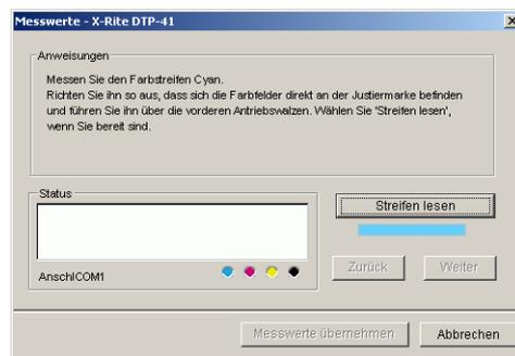
Richten Sie die Messwerteseite so im Führungsschlitz aus, dass der jeweils zu messende Farbstreifen unter der Justiermarke zentriert ist (siehe Abbildung auf Seite 74). Führen Sie die Messwerteseite über die vorderen Walzen in das Instrument ein, bis sie an die hinteren Antriebswalzen stößt (etwa 7 cm) und Sie einen Widerstand spüren.
