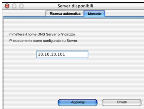
Se non è stato trovato alcun server Fiery EXP8000/50 mediante la ricerca manuale, fare clic sulla scheda Ricerca automatica e quindi su Avanzata per eseguire la ricerca tramite un intervallo di indirizzi IP oppure tramite l'indirizzo IP e la sottorete.
