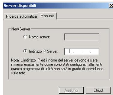
Se non è stato trovato alcun server Fiery EXP8000/50 mediante la ricerca manuale, fare clic sulla scheda **Ricerca automatica** e quindi su **Avanzata** per eseguire la ricerca tramite un intervallo di indirizzi IP oppure tramite l'indirizzo IP e la maschera di rete secondaria.
