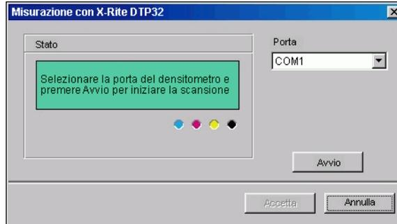
L'area Stato fornisce le istruzioni per selezionare la porta ed inserire la pagina delle misurazioni nel DTP32 quattro volte, una per ogni striscia di colore.
