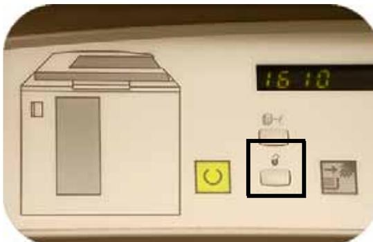
2. Sobald die Entladen-Anzeige aufleuchtet, kann der Stapelwagen geöffnet werden.
