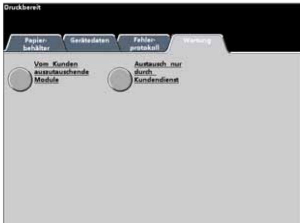
Im Bildschirm Vom Kunden auszutauschende Module wird der Zustand des jeweiligen Verbrauchsmaterials durch eine Füllstandsanzeige oder ein Häkchen angedeutet.
