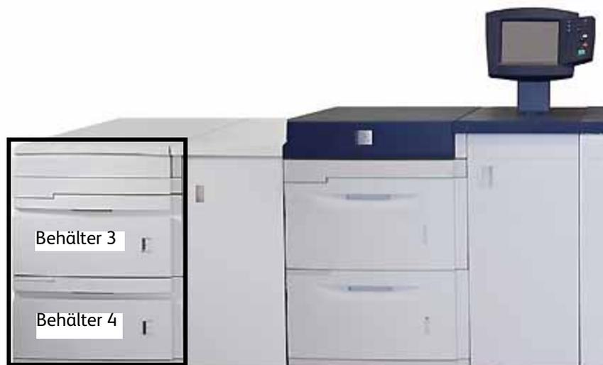
Das zweite Zufuhrmodul (ZZM) ist wahlweise verfügbar und enthält Behälter 3 und 4. Dieses Zufuhrmodul kann genau wie das erste Zufuhrmodul (EZM, Behälter 1 und 2) bestückt werden.
