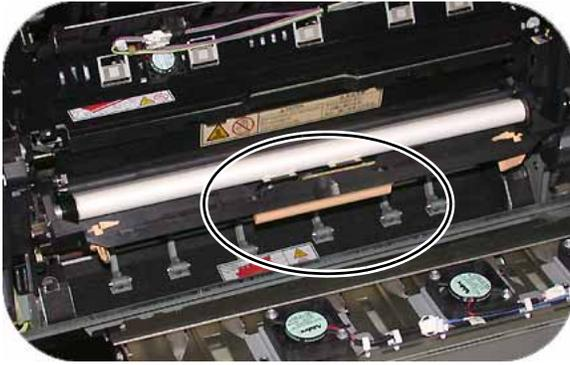
5. Die gelben Vorsprünge auf den Seiten des Fixierfilzes mit der gelben Markierung auf jeder Schiene ausrichten und den Filz bis zum Ende in den Fixierer schieben.
