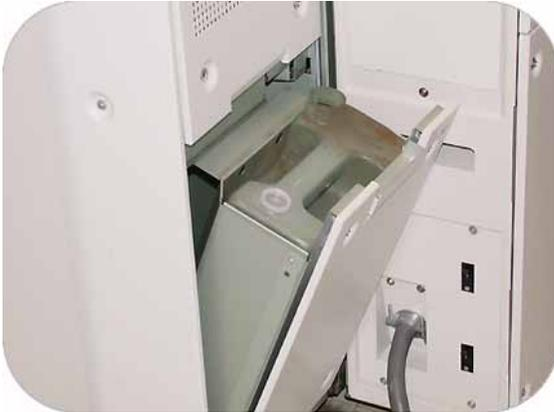
2. Die Kappe (an der Behälterseite) auf den Behälter aufsetzen und diesen den regionalen Bestimmungen entsprechend entsorgen.
