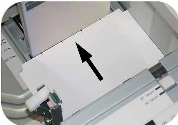
1. Registerblattmaterial im Format 228 x 279 mm so in den Behälter legen, dass die Register mit der kurzen Kante in der Führungskantenposition liegen.
