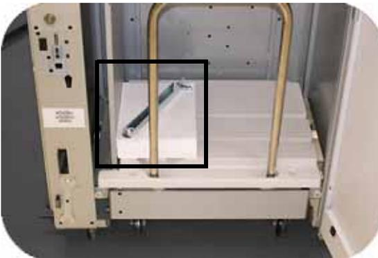
4. Den Stapelwagen gerade herausziehen. Den Sicherungshebel entfernen.
