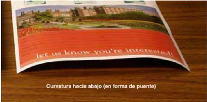
En este ejemplo, se ejecuta un trabajo de 10 páginas, a 1 cara: cara arriba, que muestra curvatura hacia abajo (en forma de puente). El trabajo contiene:
