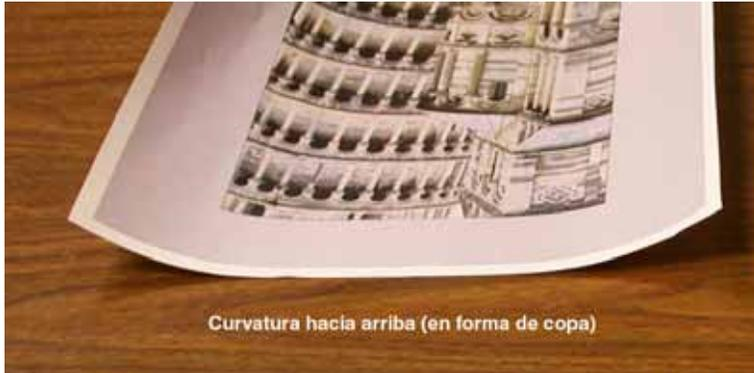
En este ejemplo se ejecuta un trabajo de 10 páginas, a 1 cara: cara arriba, que usa Papeles de diferente peso y muestra curvatura hacia arriba:
