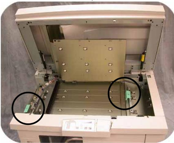
3. Levante la(s) manija(s) verde(s) que indica la IU y retire todo el papel del área del transporte auxiliar. Retire solamente el papel de las áreas indicadas.
