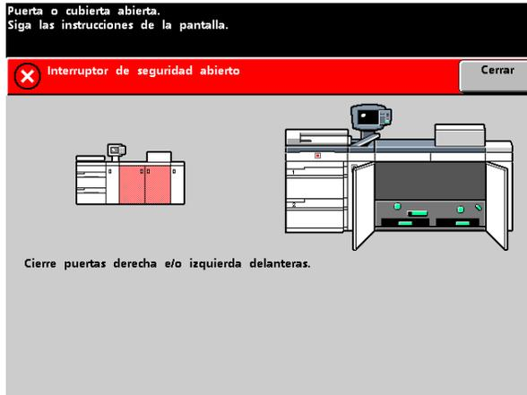
Una pantalla de *Alerta* tiene una barra roja en la parte superior cuando un suministro, por ejemplo el tóner, debe reemplazarse. Una pantalla de *Alerta* también indica cuando la prensa digital no puede hacer impresiones debido a una condición de error. Siga las instrucciones de la pantalla táctil para resolver el problema y reanudar la impresión.
