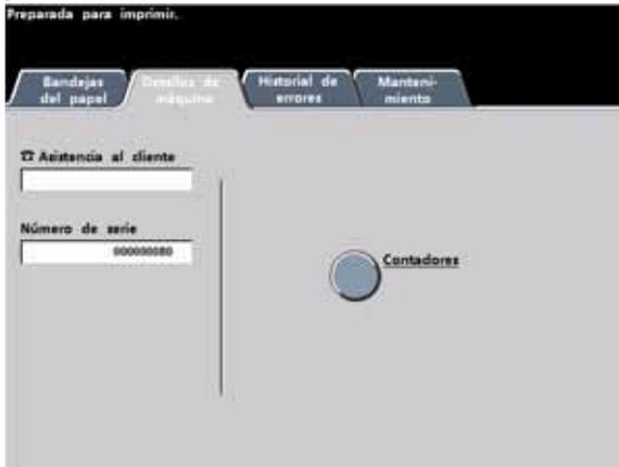
Los contadores mantienen el registro de la cuenta de impresiones. Para acceder al registro de la cuenta toque el botón Contadores en la pantalla Detalles de máquina. Se muestra la pantalla de los Contadores de facturación.
