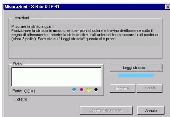
Allineare la pagina nell'alloggiamento della pagina delle misurazioni del dispositivo DTP41 in modo che la colonna del colore in esame sia centrata sotto l'indicatore di allineamento. Inserire la pagina per circa otto cm oltre i rulli anteriori fino a toccare i rulli posteriori.
