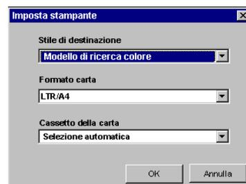
Per Stile di destinazione, selezionare l'impostazione Modello di ricerca colore o Modello di approssimazione colore. Modello di ricerca colore stampa i campioni con lo stesso formato visualizzato nella finestra Ricerca colore. Modello di approssimazione colore stampa i campioni nel formato tre colonne per otto righe.
