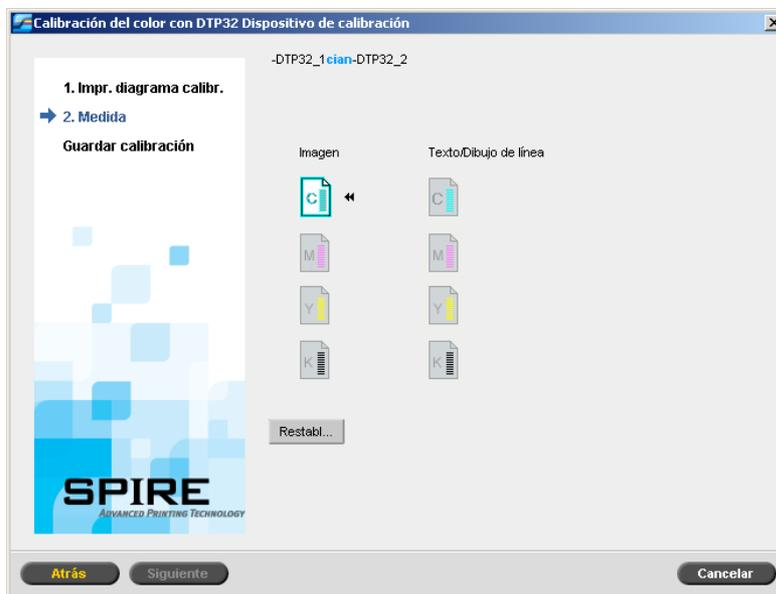
10. En el espectrofotómetro *Eye-One*, pulse el botón del lateral del espectrofotómetro y alinee el cabezal con la punta de la flecha cyan. La flecha está situada a la izquierda de la columna cyan en la Curva de calibración de densidad de imagen. Esta punta se cruza con la línea semi-punteada. Después de dos segundos aproximadamente, el espectrofotómetro emite un sonido.
