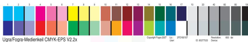
Al incorporar la tira Ugra/FOGRA Media Wedge a cualquier trabajo podrá comprobar la precisión y la coherencia del color de la digital press mediante la medición de los colores de la tira Ugra/FOGRA Media Wedge con el ES-1000 y el software compatible y comparar las mediciones con los valores de referencia.
