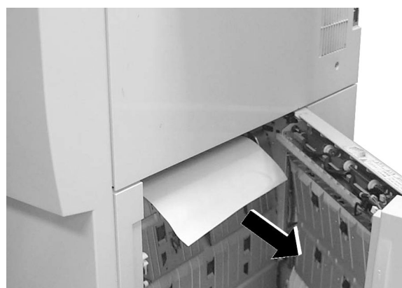
Figur 11: Fjern papir bag kopimaskinen/printerens højre låge
