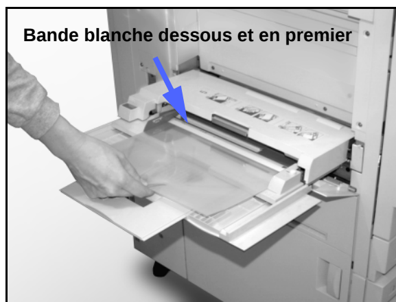
Figure 4 : Mise en place de transparents dans le magasin 5
