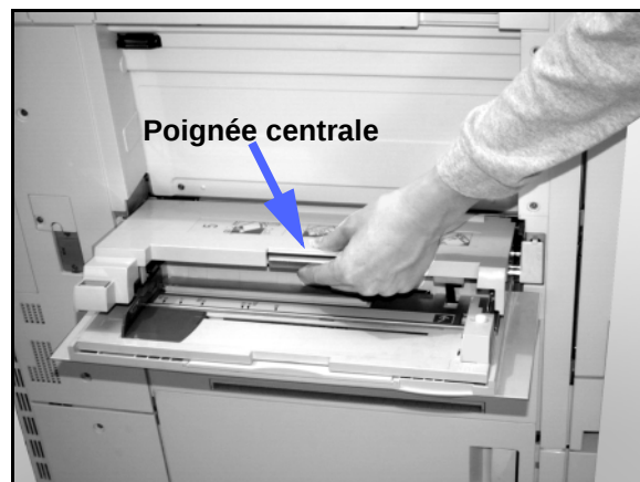
Figure 16 : Dégagement du magasin 5
