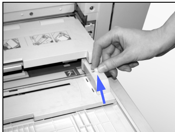
Figure 14 : Guide papier avant et vis de la languette de cadrage
