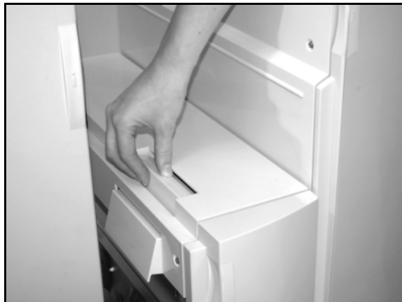
Figure 6 : Bouton de déverrouillage de la trieuse
