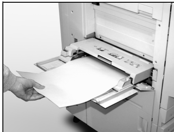
Figure 3 : Mise en place du support dans le magasin 5
