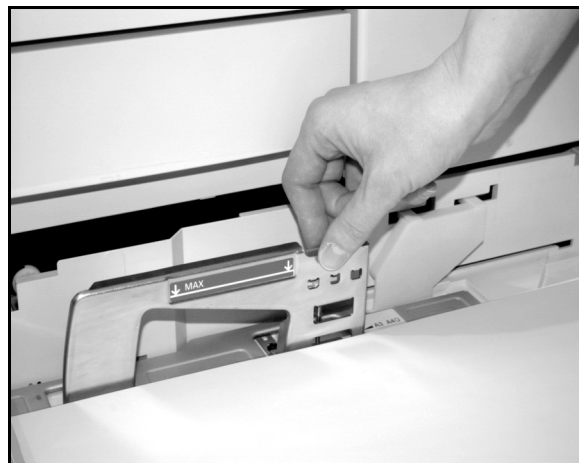
Figure 7 : Réglage du guide papier arrière
