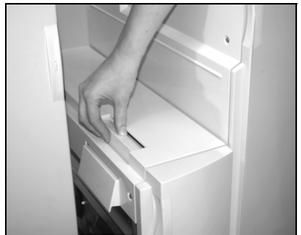
Figure 2: Bouton de déverrouillage de la trieuse
