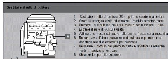
Fig. 41: Messaggio “Controllare rullo di pulitura”
