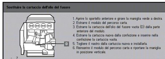
Fig. 34: Messaggio “Controllare l’olio del fusore”
