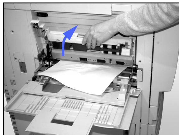
Figura 17: Sollevamento della parte superiore del vassoio 5
