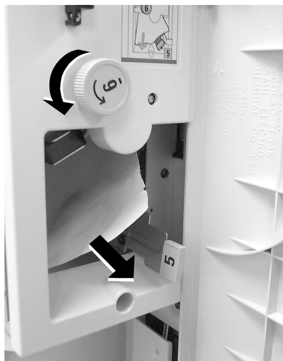
Figura 13: Rotazione della manopola 6 e rimozione della carta inceppata
