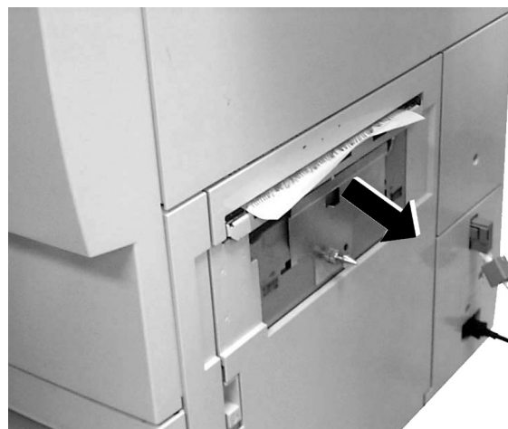
Figura 10: Rimozione della carta dall'area di interfaccia
