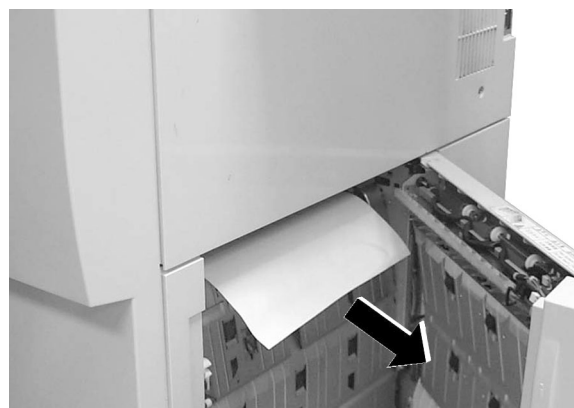
Figuur 11: Papier achter rechterdeur van kopieerapparaat/printer verwijderen
