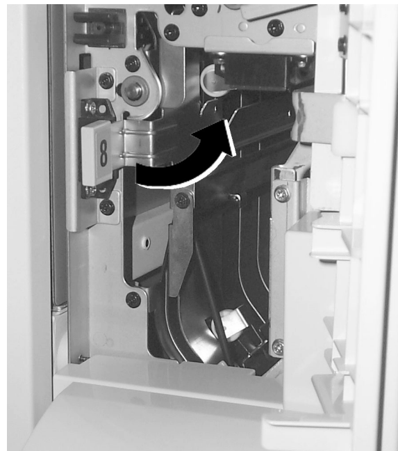
Figura 16: Deslocar a Pega 8 para a direita
