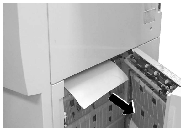
Figura 11: Retirar papel por trás da Porta Direita do copiador/impressora
