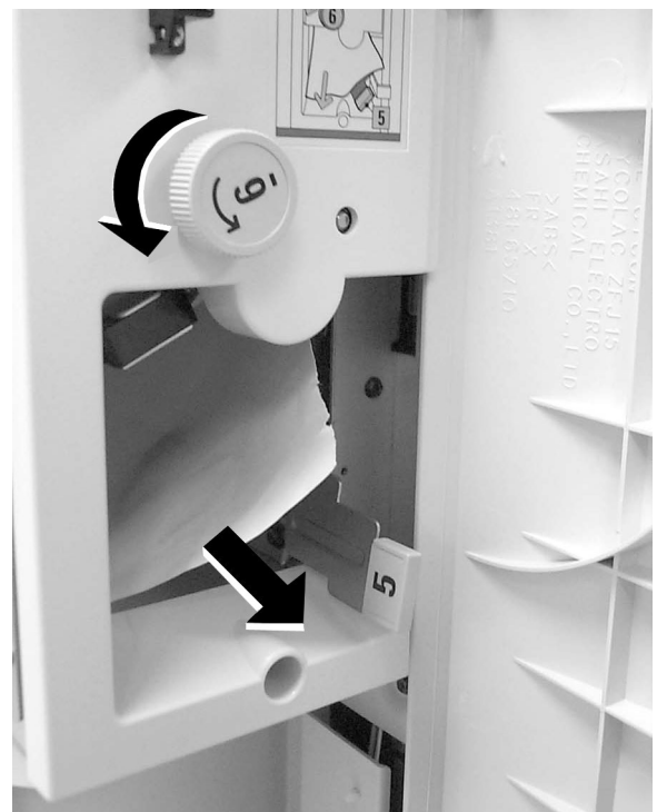
Figura 13: Rodar o Botão 6 e retirar o papel encravado
