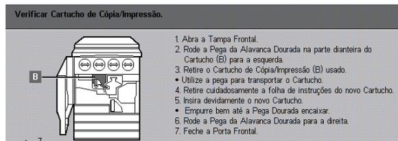
**Figura 22: Mensagem de Substituição do Cartucho de Cópia/Impressão**
