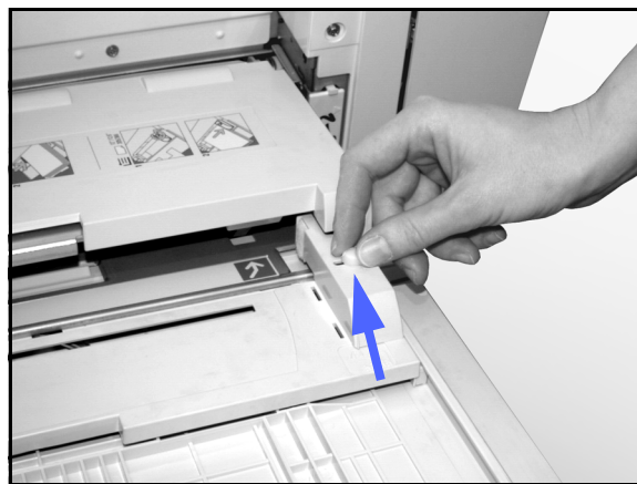
Figura 14: Guia de papel dianteira e parafuso de aperto manual do registro
