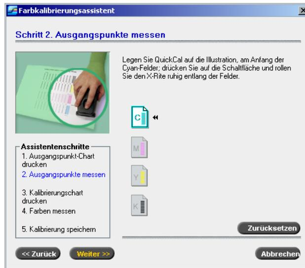
9. Während Sie auf die Taste auf dem X-Rite DTP34 drücken, richten Sie den Kopf des X-Rite DTP34 an der Pfeilspitze von Cyan aus. Der Pfeil befindet sich links der Cyan-Spalte auf der Image Density Calibration Curve. Die Pfeilspitze durchschneidet die halbpunktierte Linie.
