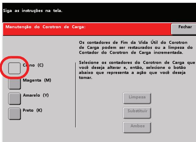
Após incrementar o contador para um corotron específico (ou corotrons), este corotron específico (ou corotrons) não estará mais selecionável.
