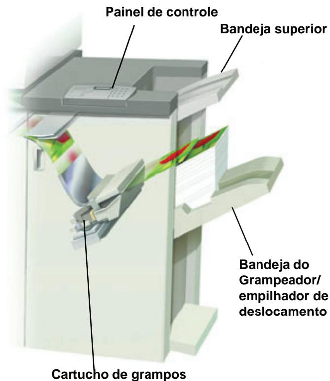
À medida que o material entra no GEC, ele é alimentado pela Bandeja superior ou pela Bandeja do Grampeador/empilhador de deslocamento do GEC, dependendo das seleções feitas.
