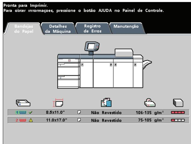
As Bandejas 3 e 4 só aparecerão na coluna Papel quando um segundo Módulo de Alimentação opcional for conectado à impressora digital.
