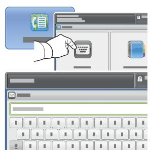
Для отправки факсов **нажмите Ввести получателя** и введите номер факса с буквенноцифровой клавиатуры на сенсорном экране, затем нажмите **Добавить**. Для добавления к списку дополнительных номеров факса нажмите **Добавить получателя**.
